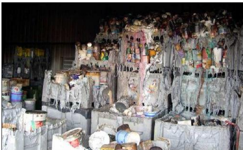
Incendie de DMS suit à une réaction d'incompatibilité
