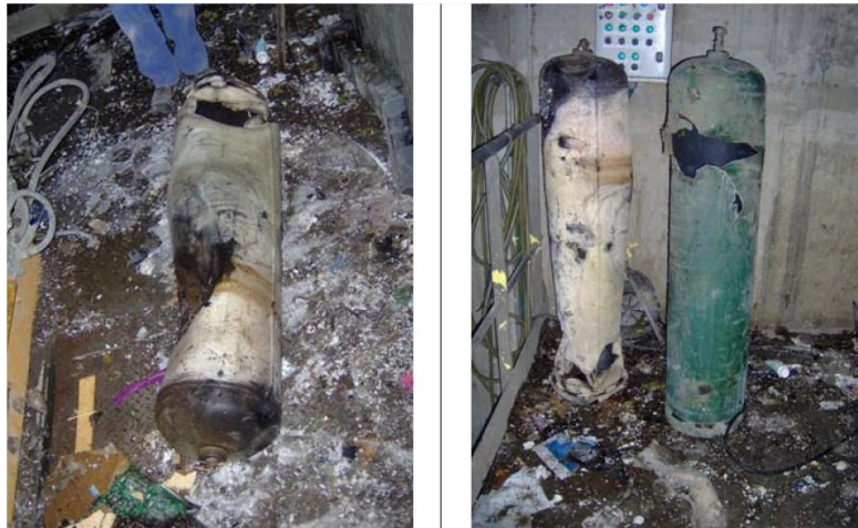
Bouteilles de propane retrouvées mêlées aux déchets dans un broyeur
